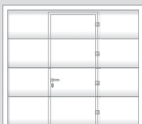
Colocación simétrica para anchos de puerta de garaje de hasta 3.500 mm
