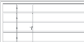
Colocación asimétrica para anchos de puerta de garaje por encima de 3.500 mm, izquierda o derecha
