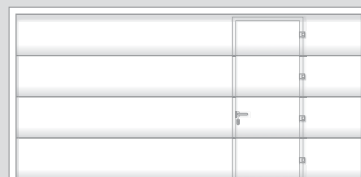
Colocación asimétrica para anchos de puerta de garaje por encima de 3.500 mm, izquierda o derecha
